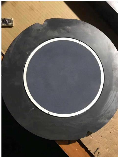
四、固化:待耐磨涂层完全固化后(常温24小时),即可投入使用。注意事项:1、每次配胶不超过4kg为宜,配好的胶在30min内用完,以免胶固化造成浪费。2、材料配制时,称量要准确,混合要均匀,涂抹时胶层要压实3、温度低于15度时,涂层固化慢,固化不完全,可以在涂层初步固化后,用碘钨灯或电热风等设备加热到80°C~100°C保温2个小时。26、耐磨陶瓷涂层(环氧树脂胶粘涂层)耐磨性优良,被大量应用于材料保护和零件的修复,比如零件的划伤,铸造缺点、外部裂纹、零件磨损、零件渗漏等。由于修复工作简便,经济可行,因此该工艺方法日益受到了人们的重视。
